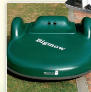
Dank der Begrenzungsschleife lassen sich Blumenbeete aussparen und wird dicht an den Kanten entlang gemäht.
